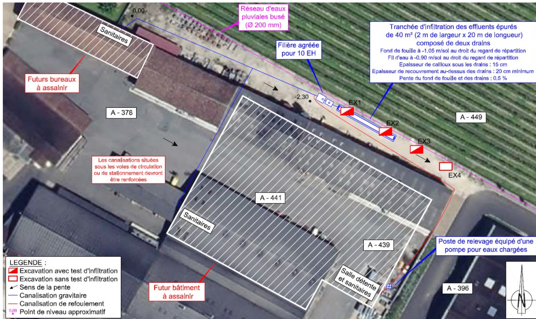
FIGURE 31 : SCHEMA DE PRINCIPE DU DISPOSITIF D'ASSAINISSEMENT INDIVIDUEL
